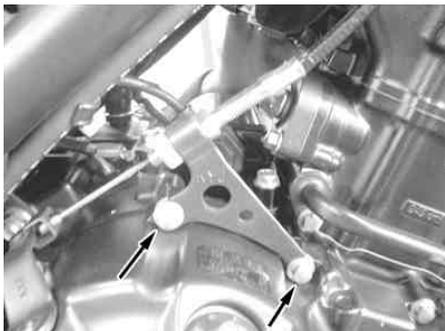
ウォーターパイプ、ボルトを取り付け、ボルトを確実に締め付ける。
