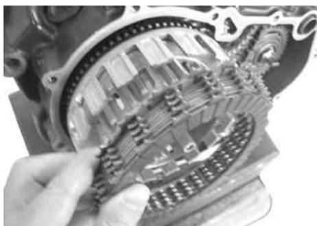
クラッチセンターナットのかしめを外す。メインシャフトのネジ部を損傷しないように注意する事。専用工具を使用して、クラッチセンターを保持しながらクラッチセンターロックナットを緩める。
