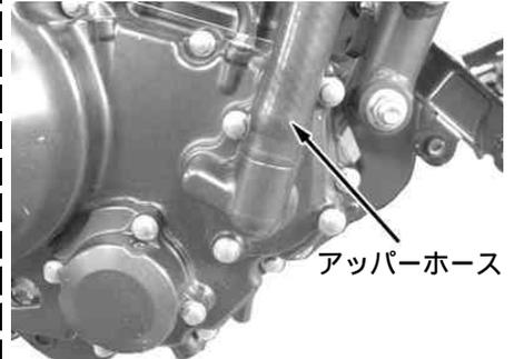
ホースクランプの沈み込み量が規定値になるまでクランプのスクリューを締め付ける。
