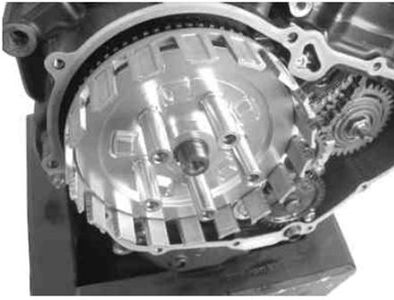
キット付属のクラッチセンターロックナットの座面にエンジンオイルを塗布する。ワッシャ、クラッチセンターロックナットの順でメインシャフトに取り付け仮締めします。クラッチセンターとクラッチハブの摺動部にエンジンオイルを塗布します。クラッチセンターを取り付け、専用工具を使用して、クラッチセンターを保持しながらクラッチセンターロックナットを指定トルクで締め付ける。
