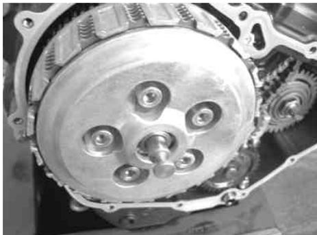
取り外したクラッチスプリングを取り付けクラッチプレッシャープレートボルトを取り付ける。
