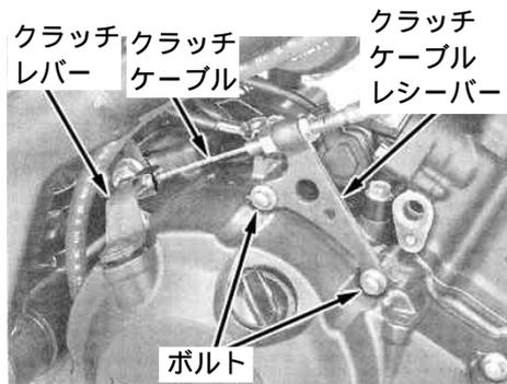
ロックナットを緩め、アジャスターナットを回して遊びを調整する。
