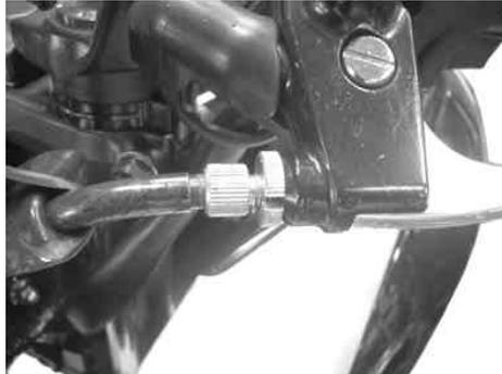
アジャスターのネジ部の掛かり代が少ない場合は、アジャスターを一杯にねじ込み、1回転戻した後、クラッチアーム側で調整を行う。掛かり代が少ない状態でクラッチレバーを操作するとネジ部を損傷することがある。
