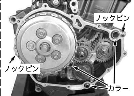
クラッチレバーを時計方向に回転させて、クラッチレバーをクラッチリフターピンに合わせながら、R.クランクケースカバーを取り付ける。
