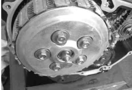
クラッチプレッシャープレートボルトを対角に2～3回に分けて指定トルクで締め付ける。規定トルク以上で締め付けると、クラッチハブが破損するので注意する事。
