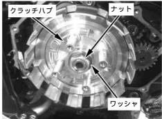
クラッチセンターを取り付け、専用工具を使用 してクラッチセンターを保持しながらクラッチ ハブナットを指定トルクで締め付ける。
