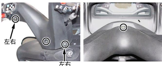
2. ワイヤー及びケーブル類をハンドルに固定してあるタイラップを、ニッパー等で切断し、左レバーホルダー及び右ハンドルスイッチの配線接続を外して下さい。
