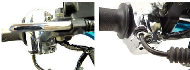
6. 右ハンドルスイッチ A S S Y（フロント側）にスロットルケーブルを通し、純正スクリーンにて固定し、スロットルケーブルをスロットルハンドルに取り付け、右ハンドルスイッチ A S S Y（リア側）を嵌め合わせ、上側を ボタンヘッドスクリュー（M 5 × 2 5）下側を ボタンヘッドスクリュー（M 5 × 2 0）1本にて固定して下さい。
