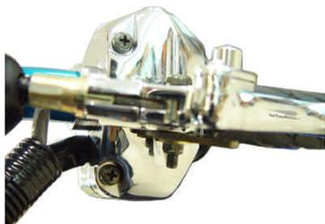
5. 右ハンドルスイッチを固定してあるスクリーン2本を緩め、右ハンドルスイッチをハンドルより取り外して下さい。この時、スロットルケーブルを右ハンドルスイッチに固定してあるスクリーンを緩め、スロットルグリップよりスロットルケーブルを取り外して下さい。
