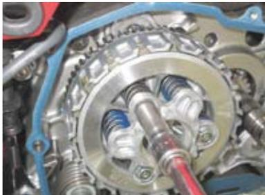
○遠心クラッチアウタとクラッチ ASSY. を一体で、各シャフトに取り付ける。
