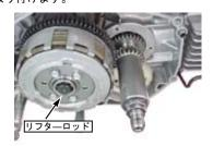
3. クランクケースのクラッチカバー取り付け面を脱脂し、ノックピン2本を入れて新品のクラッチカバーガスケットを取り付けます。R. クランクケースカバーを取り付け、締め付け順序に従って、付属のソケットキャップスクリューで数回に分けて締め付けます。
