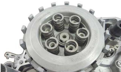
※組み付け後、クラッチレバー操作が重いと感じた場合は別途軽荷重クラッチスプリング：(02-01-0513)をご用意頂き、下図を参考にスプリングを取り付けて下さい。
