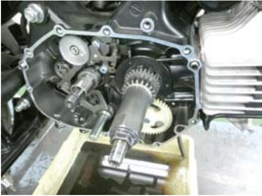
○ノーマルクラッチに取り付けられていたスペーサー、カラーを取り付け、クラッチアウターを取り付けます。
