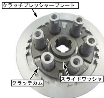
○クラッチフリクションディスク、クラッチプレートをクラッチセンターとクラッチプレッシャープレートへ写真の様に組み込みます。
