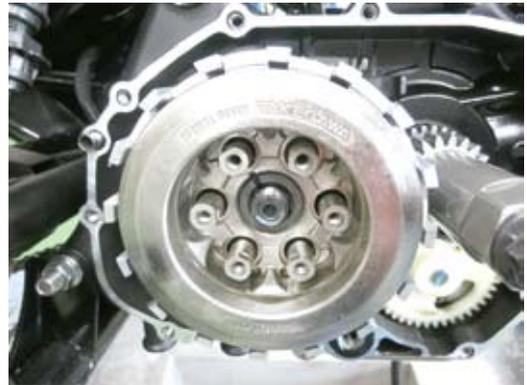
○コニカルスプリングワッシャ 14mm、ロックナット 14mm を取り付け規定トルクで締め付けます。
