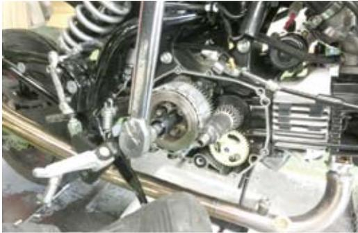
○クラッチプレッシャープレートのボス部にクラッチスプリングを取り付けます。
