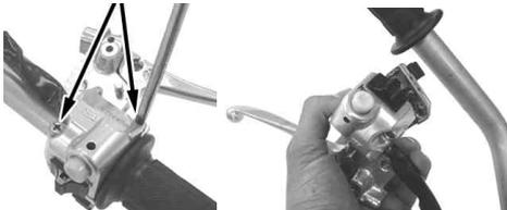
8. コンビネーションスイッチのスクリューを外して、ハウジングを分割します。ハンドルパイプにスイッチを取り付け、スクリューを締め付けます。
