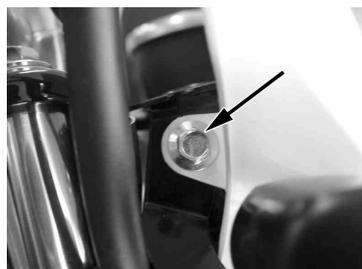
5. ヘッドライトカウルに取り付けているヘッドライトソケットに写真の様にヘッドライトコードを接続します。
