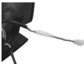
6. ウインカースイッチ本体より出ているコードのコンネクター及び、ギボシを全て外します。
