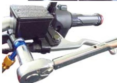
○純正クラッチレバーから外したコネクタの配線と、クラッチマスターシリンダー ASSY. の配線を適当な長さにカットし、付属のオスメギボシにて接続する。
