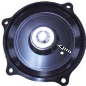
○クラッチカバーにOリング120mmを取り付け、Oリングにエンジンオイルを薄く塗布する。
