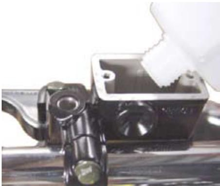
○ブリーダースクリューにビニールチューブを取り付け、チューブの反対側に適当なカップ等で受ける様にする。クラッチレバー先端がハンドルグリップに当たるまで握り、ブリーダースクリューを約1/2回転緩め、再び締め付け、クラッチレバーをゆっくり放し、完全に戻ったらそのまま数秒間放置する。
