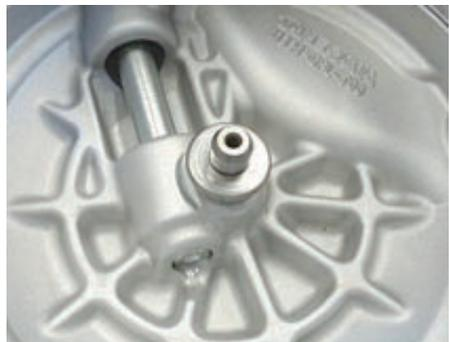
○クラッチカバーをR. クランクケースカバーにはめ込み、ソケットキャップスクリュー 6x15 で取り付け規定トルクで締め付けます。
