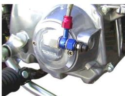
1. エンジン停止状態でトランスミッションを1速にシフトレクラッチレバーを握ります。車両を動かした際リヤホイールが回転しクラッチレバーを放した状態でリヤホイールが回転しないことを確認して下さい。
