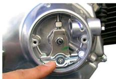
3. フラットスクリューを外し、クラッチリフタープレート、リフターセッティングプレートを取り外します。
