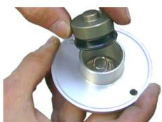
1. リリースブラインドプラグのOリングがついていることを確認し、リリースブラインドプラグのフラット面からクラッチレバーCOMP.の入っていた穴に入れてクラッチレバーストッパーピンで止めます。
