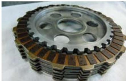
○②クラッチカムにエンジンオイルを塗布した③スライドワッシャを取り付け、④クラッチセンターに取り付けます。
