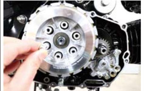
○図を参考にし、②クラッチカムの上に⑨スラストワッシャ (Φ 17x Φ 28x t 2.0) を入れ、純正ワッシャ (Φ 14.2x Φ 26x3)、クラッチセンタナットを仮止めします。
