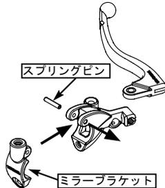
7. クラッチレバーをハンドルに取り付け、ボルトを締め付けます。
