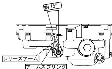
レリーズアームにソケットキャップスクリューを取り付け、レリーズアームを軽く下方向に押さえた状態で、ソケットキャップスクリューを締め付けます。
