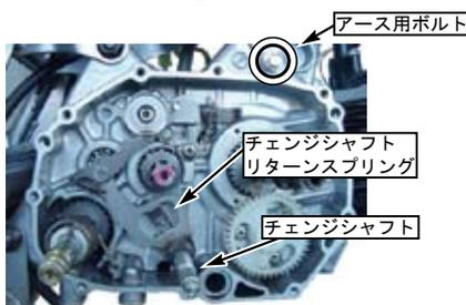
8. クランクケースのエンジンアース用ボルトを取り外します。(KSR110 のみ)
