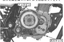
○クラッチリフタープレートボルトを対角に 数回に分けて緩め、リフタープレートボルト 4本、リフタープレート / ベアリング、クラッチ スプリング 4 本を取り外します。
