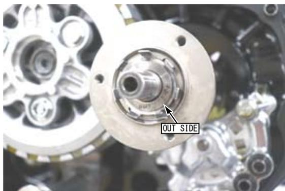
○①プライマリードライブギアの上に③オイルフィルターガスケット、②オイルフィルターカバーの順に取り付け、④ソケットキャップスクリュー 5x10 にネジロック剤を塗布し規定トルクで固定します。推奨ネジロック剤：LOCTITE271
