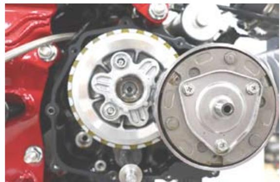
○オイルフィルターロータカバーを固定しているスペシャルフランジボルト M5x8 を 3 個取り外し、オイルフィルターロータカバーを外します。
