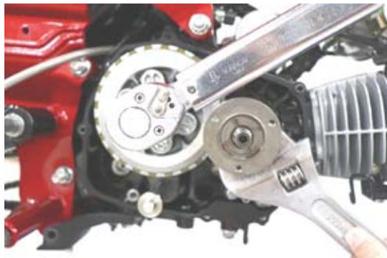
○①プライマリードライブギア 19T の溝に、ロックワッシャの爪部を合わせ、次にロックワッシャ B の、[OUT SIDE] が外側に向く様にセットし、ロックナットを取り付け、①プライマリードライブギア 19T を固定した状態でロックナットを規定トルクで締め付けます。ロックワッシャの爪とロックナットの位置を合わせ写真の様に折り曲げます。
