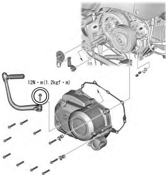
○オイルフィルターロータカバーを固定しているスペシャルフランジボルト M5x8 を3個取り外し、オイルフィルターロータカバーを外します。
