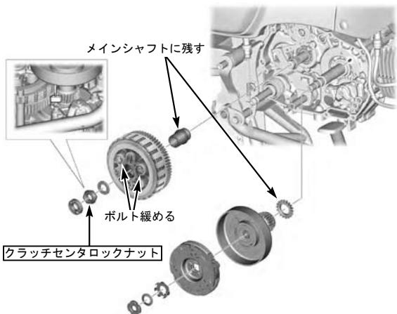
○図を参考に③クラッチアウターCOMP.のボス部にオイルを塗布し、純正のスライドワッシャ17mmをメインシャフトに入れます。
