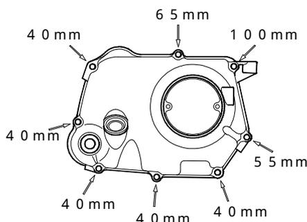
キックスタータを取り付け、ボルトを締め付けます。
