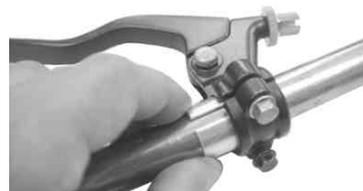
キットのクラッチケーブルを取り付けます。クラッチレバー/ホルダー、クラッチケーブルは給油脂の必要があります。
