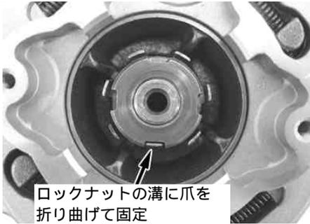
ロックナットの溝に爪を折り曲げて固定
