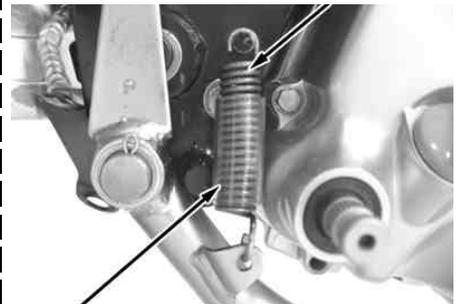
スプリングカバーを取り付け、スプリングの取り付け方向を上下左右逆にする
