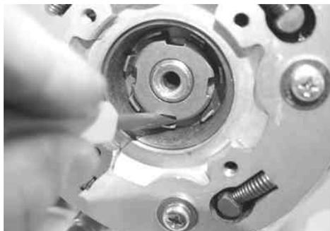
クラッチアウトを保持し、ロックナットレンチを用いてロックナットを取り外します。
