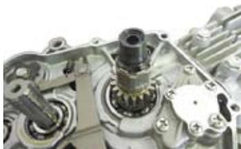
ロックナットに爪を密着させる
