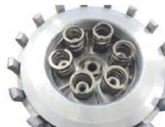
○クラッチリフタープレート COMP. のベアリング面を外側にしてソケットキャップスクリュー 5x20 を組み付け手でいっぱい締め付けます。クラッチリフタープレート COMP. を手で引っ張りフリクションディスクに隙間が出来る時はクラッチセンターとクラッチプレッシャープレートの噛合わせがずれています。その際は、クラッチリフタープレート COMP. を左右に回転させ、クラッチセンターとクラッチプレッシャープレートを噛合わせます。噛合った状態でクラッチリフタープレート COMP. を手前に引っ張りながらソケットキャップスクリュー 5x20 を対角に徐々に締め付け、最後に規定トルクで締め付けます。
