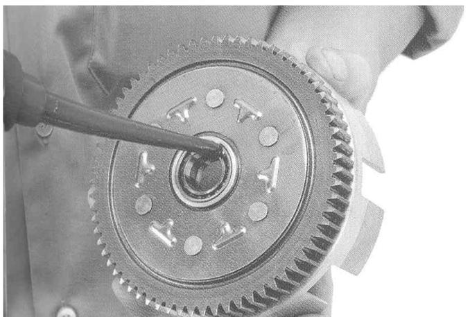
2. トランスミッションメインシャフトに、スラストベアリングシート、スラストベアリング、スラストワッシャ、ワッシャの順に差し込み、クラッチアウターCOMP.を取り付けます。
