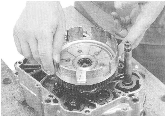
3. ギヤホルダー等を使用し、クランクシャフトの回り止めをした状態でロックナットを指定トルクで締め付けて、ロックワッシャの爪を折り曲げます。
