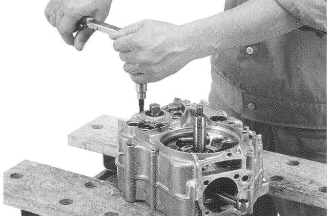
4. クランクケースにギヤシフトスピンドルCOMP.を取り付け、シフトドラムストッパープレート、シフトドラムストッパーバースプリング、シフトドラムストッパーCOMP.を取り付け、ボルトを指定トルクで締め付けます。
