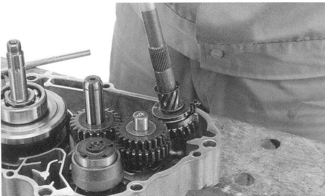
3. クランクケース合わせ面を清掃し、ロックピン2本と新品のクランクケースガスケットを取り付け、左右のクランクケースを合わせてボルトを対角に数回に分けて指定トルクで締め付けます。
