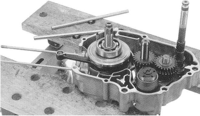
2. キックスタータースピンドルを外し、トランスミッション、ギヤシフトドラムを一体で取り外します。
