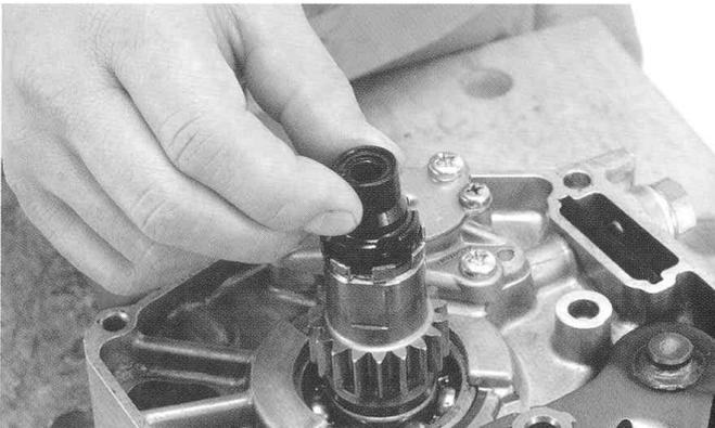
2. トランスミッションメインシャフトに、スラストベアリングシート、スラストベアリング、スラストワッシャ、ワッシャの順に差し込み、クラッチアウターCOMP.を取り付けます。スラストベアリングシートの突起部がクランクケースに引っ掛かり、回転しない位置に合せて下さい。スラストワッシャ及び、クラッチアウターボールベアリング部にエンジンオイルを塗布して下さい。
