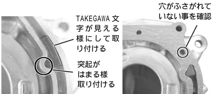
10. ケース合わせ面を清掃し、ノックピンと新品のガスケットを取り付け、Mgカバーを取り付けます。
