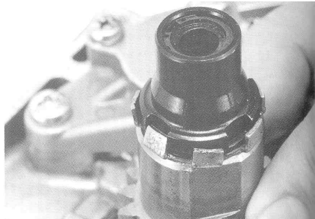
ロックナットに爪を密着させる
