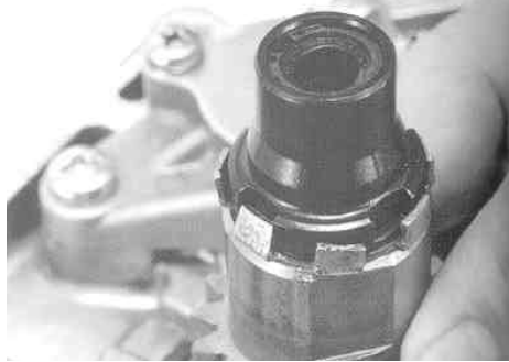
ロックナットに爪を密着させる
