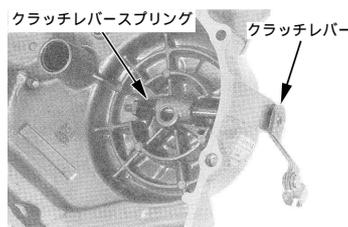
9. ダイカストカバーに取り外したクラッチレバースプリングとクラッチレバーを、ノーマル同様に取り付けます。クラッチレバーシャフト部にエンジンオイルを塗布して下さい。
