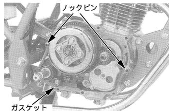
7. クラッチリフターピンをキット内のリフターピンに交換します。ノーマル部品と長さが異なりますので、必ず交換して下さい。
