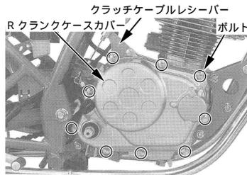
5. R クランクケースカバーのボルトを外し、R カバーを取り外します。
