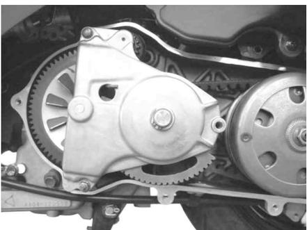
3. 写真を参考にしライトキックスタータナットを取り外し、フィクストドライブフェイスを外します。
