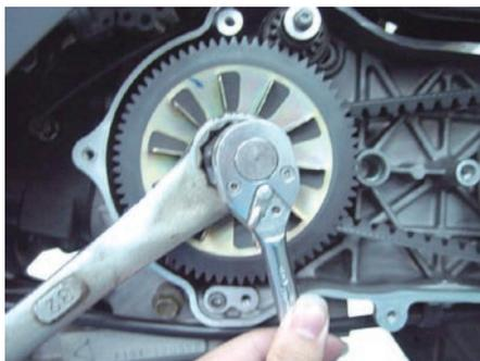
4. Vベルトを写真の状態までずらし、ムーバブルドライブフェイスを取り外します。
