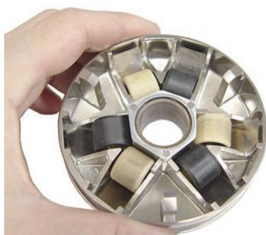
6. ランププレートにスライダが取り付けられている事を確認し、取り付け要領5で組み立てたプーリーに取り付けます。
