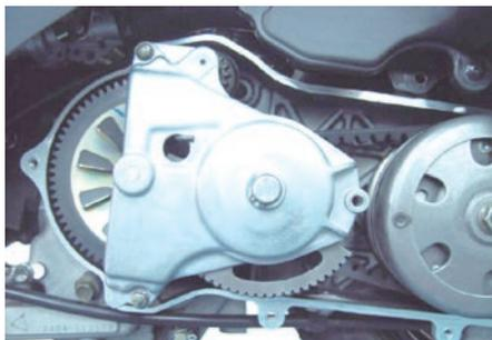
3. 写真を参考にしライトキックスタータナットを取り外し、フィクストドライブフェイスを外します。
