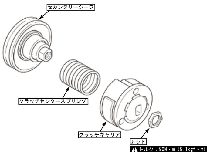
4. クラッチセンタースプリングを、純正スプリングから商品のスプリングに交換し、分解の逆手順で元通り組み付ける。
