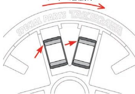
○プーリーをクランクシャフトに取り付け、ドライブベルトをドライブフェイスボスに通す。
