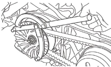
○付属のプーリーに付属のウエイトローラーをセットし、ノーマルのドライブフェイスボスと付属のランププレート / スライドピースを取り付ける。
