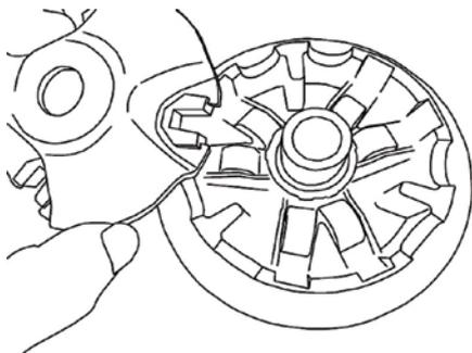
※ウエイトローラーの樹脂の折り返しがムーバブルドライブフェイスの回転方向と反対になるようセットする。
