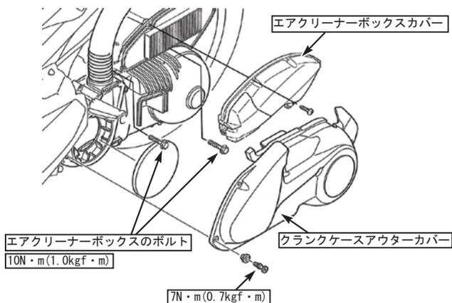
○ボルトを取り外し、エアダクトの接続を外した後、クランクケースカバー / ガasketを取り外す。
