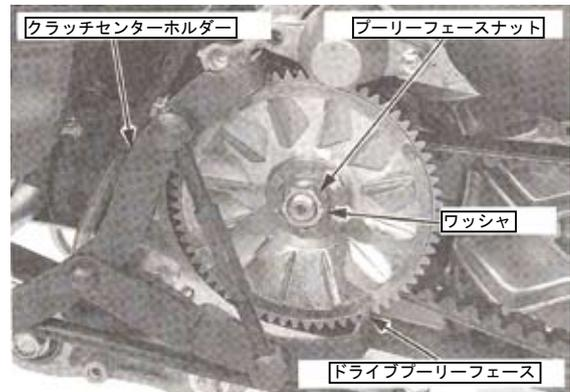
4. ムーバブルドライブフェースを、裏側のランププレートを押さえウェイトローラーが落下しないよう注意しながら、ドライブフェースボスと共に取り外して下さい。
