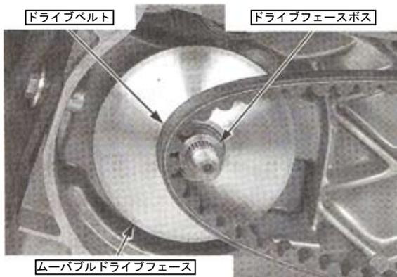
9. ドライブプリーフェース、ラチェットプレート、ワッシャをクランクシャフトに取り付け、クラッチセンターホルダーにてドライブプリーフェースを固定しながら、プリーフェースナットを規定トルクにて締め付けて下さい。
