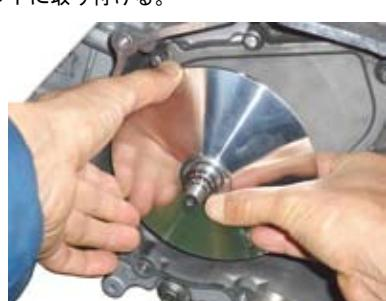
○ドライブベルトをドライブフェイスボスに通す。
