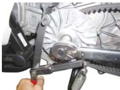
○ドライブフェイスを数回転手で回し、ドライブベルトをなじませる。
