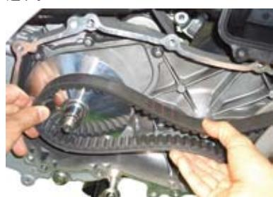
○ドライブフェイスをクランクシャフトのスプライン形状に合わせて取り付ける。
