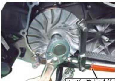
○付属の①プーリーに付属の④ウエイトローラー(10g)をセットし、ノーマルのドライブフェイスボスと付属の②ランププレート / ③スライドピースを取り付ける。
