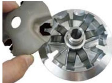
○④ウエイトローラー(10g)が脱落しないように②ランププレートを押さえながらクランクシャフトに取り付ける。
