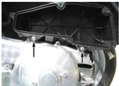
○ボルト14本を取り外し、L. クランクケースカバー / ガスケットを取り外す。ノックピン2個を取り外しておく。
