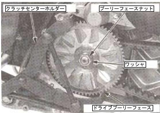
4. ムーバブルドライブフェースを、裏側のランププレートを押さえウエイトローラーが落下しないよう注意しながら、ドライブフェースボスと共に取り外して下さい。
