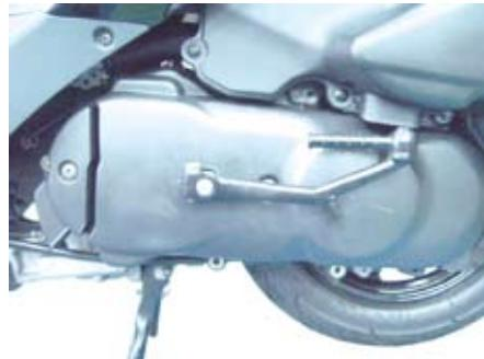
2. キックスターターカバーを固定しているボルトを外し、キックスターターカバーを取り外します。
