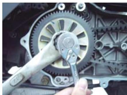
4. Vベルトを写真の状態までずらし、ムーバブルドライブフェースとドライブフェイスボスを取り外します。
