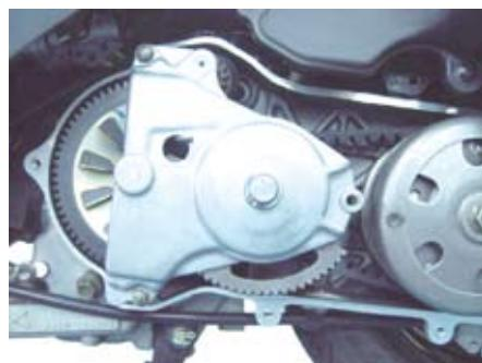
3. 写真を参考にしライトキックスターナットを取り外し、フィクストドライブフェイスを外します。
