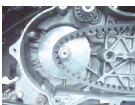
5. ①ブーリーに④と⑤のウェイトローラーを交互にセットし、⑥ドライブフェイスボスと②ランププレート／③スライドピースを取り付けます。
