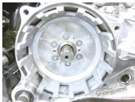
※クラッチアウターを取り外す時、抜けにくい場合は2つのM5 タップ部にフラットヘッドスクリューを均一に締め込むとプライマードリブンギア ASSY. から分離します。
