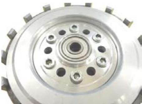
7. 油圧式のクラッチカバーキット装着車両は、クラッチリフタープレート COMP. のベアリングにクラッチリフターロッドを組み付けます。
