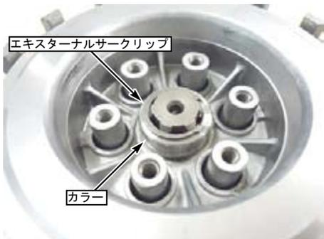
5. クラッチプレッシャープレートのボス部にクラッチスプリングを取り付けます。
