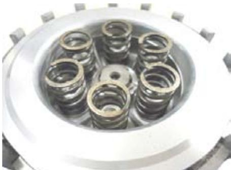
6. クラッチリフタープレート COMP. のベアリング面を外側にしてソケットキャップスクリュー 5x20 を組み付け、手でいっぱいまで締め付けます。
