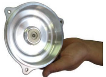
3. クラッチカバーをR. クランクケースカバーにしっかりとはめ込みソケットキャップスクリュー6x15で取り付け、規定トルクで締め付けます。
