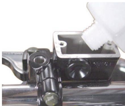
2. ブリーダervalブにビニールチューブを取り付け、クラッチレバー先端がハンドルグリップに当たるまで握り、ブリーダervalブを約1/2回転緩め、再び締め、クラッチレバーをゆっくり放し、完全に戻ったらそのまま数秒間放置します。ビニールチューブから気泡が出なくなるまでこの操作を繰り返します。
