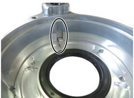
3. 組み付けが完了すればサークリップの合い口隙間をパーテーションプレート COMP. の突起に合わせ、組み付けます。
