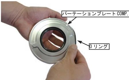
2. パーテーションプレート COMP. の突起を R. クランクケースカバー ASSY. のキック側にある凹みに合わせ組み付けます。
