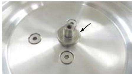
○クラッチカバーをR. クランクケースカバーにはめ込み、ソケットキャップスクリュー 6x15 で取り付け、規定トルクで締め付けます。
