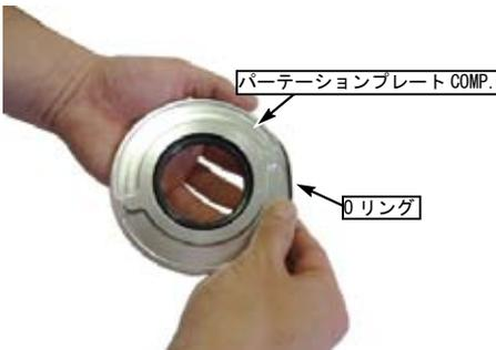
○パーテーションプレート COMP. の突起を R. クランクケースカバー ASSY. のキック側にある凹みに合わせ組み付けます。
