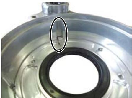
○組み付けが完了すればサークリップの合い口隙間をパーテーションプレート COMP. の突起に合わせ、組み付けます。
