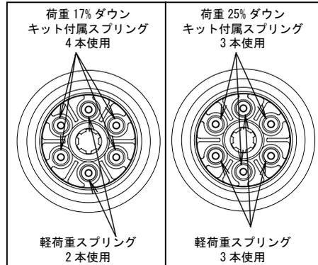
※クラッチスプリングを硬くしたい場合、クラッチセンターの各スプリング座面部に写真の様にキット付属のシムリング（最大2枚まで）を取り付けてからスプリングを取り付けて下さい。
