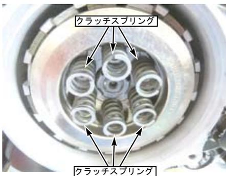
※組み付け後、クラッチレバー操作が重いと感じた場合は別途軽荷重クラッチスプリング：(02-01-0513)をご用意頂き、下図を参考にスプリングを取り付けて下さい。
