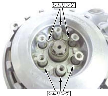
※スーパーヘッド4V+R ボアアップキット 181cc とビッグスロットルボディキットを使用されている場合、キット付属スプリングにシムを1枚組み合わせた状態を基準として調整して下さい。
