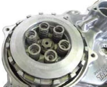
※組み付け後、クラッチレバー操作が重いと感じた場合は別途軽荷重クラッチスプリング：(02-01-0513)をご用意頂き、下図を参考にスプリングを取り付けて下さい。ただし、軽荷重クラッチスプリングを併用されるとフリクションディスクの圧着力が軽くなりますのでハイパワーエンジンではクラッチが滑りやすくなります。エンジン仕様に見合った圧着力に調整して下さい。
