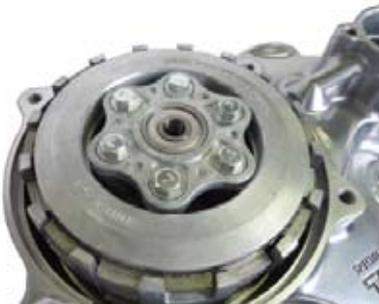
○油圧式のクラッチカバーキット装着車両は、クラッチリフタープレートCOMP.のベアリングにクラッチリフターロッドを組み付けます。
