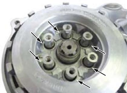
○クラッチリフタープレートのベアリング面を外側にして6角ボルト5x20にワッシャを組み付け手でいっぱい締め付けます。クラッチリフタープレートを手で引っ張りフリクションディスクに隙間が出る時はクラッチセンターとクラッチプレッシャープレートの噛み合わせがずれています。その際は、クラッチリフタープレートを左右に回転させ、クラッチセンターとクラッチプレッシャープレートを噛み合わせます。噛み合った状態でクラッチリフタープレートを手前に引っ張りながら6角ボルト5x20を対角に徐々に締め付け、最後に規定トルクで締め付けます。
