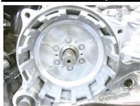
※クラッチアウターを取り外す時、抜けにくい場合は2つのM5タップ部にフラットヘッドスクリューを均一に締め込むとプライマリードリブンギア ASSY. から分離します。
