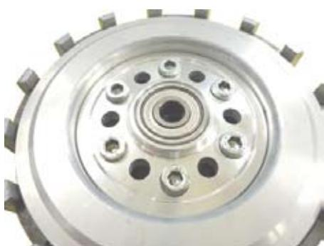
○油圧式のクラッチカバーキット装着車両は、クラッチリフタープレート COMP. のペアリングにクラッチリフターロッドを組み付けます。
