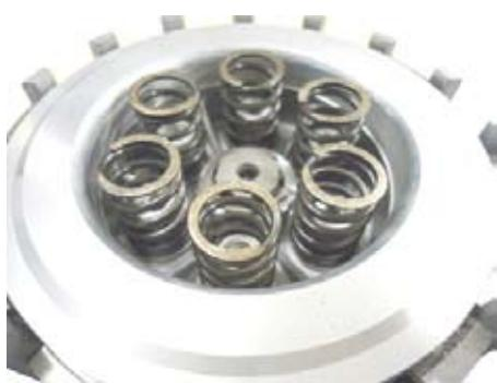
○クラッチリフタープレート COMP. のベアリング面を外側にしてソケットキャップスクリュー 5x20 を組み付け、手でいっぱいまで締め付けます。
