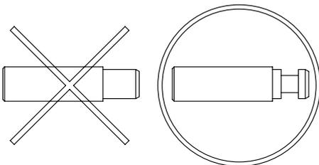
⚠ 注意：対象外のオイルホールプラグを使用した場合、オイル通路が遮断され、エンジンが破損する可能性がある。
