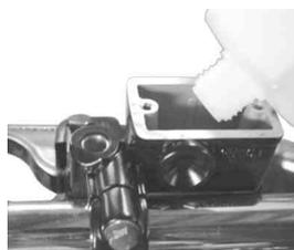
2. ブリーダースクリューにビニールチューブを取り付け、クラッチレバー先端がハンドルグリップに当たるまで握り、ブリーダースクリューを約1/2回転緩め、再び締める。クラッチレバーをゆっくり放し、完全に戻ったらそのまま数秒間放置する。ビニールチューブから気泡が出なくなるまでこの操作を繰り返します。
