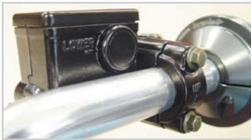
ハンドルブラケットのUPマークを上向きにし、マスターシリンダー ASSY. を取り付けます。フランジボルトを上下の順に規定トルクで締め付けて下さい。
