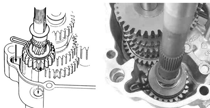
フリクションスプリングをL.クランクケースの溝に合わせてスタータースピンドルを取り付けます。
