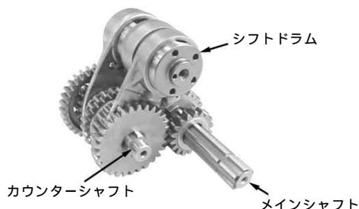
2. メインシャフト、カウンターシャフト、シフトドラムを一体で、クランクケースに、組み付けます。ミッションがニュートラル状態（ニュートラルスイッチとスイッチローターの位置が合っている所）で組み付けて下さい。スラストワッシャの組み忘れに注意して下さい。又、ノーマルのワッシャは使用しませんので取り外して下さい。カウンターシャフト用オイルシールのリップがめくれ上がらない様に、注意してシャフトを取り付けて下さい。
