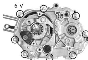
6. シフトドラムサイドワッシャの角が丸くなっている方をシフトドラム側に向け、6角ボルトを規定トルクで締め付けます。
