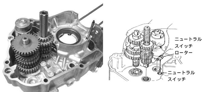
3. キックスターースピンドルよりワッシャ17MM、セットリング20MM、スタータドライブブラチェット、セットリング20MM、スラストワッシャ20MMスターターピニオンの順に取り外します。キックスターースピンドルにキット内スターターピニオンを取り付け、逆手順で外した部品を組み付けます。
