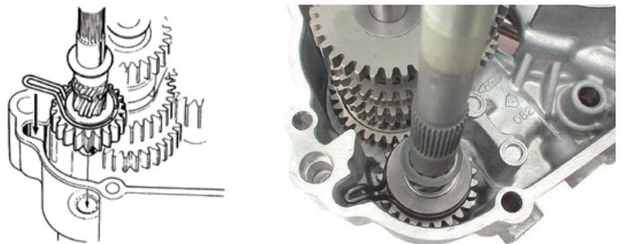
フリクションスプリングを左クランクケースの溝に合わせてスタータースピンドルを取り付けます。
