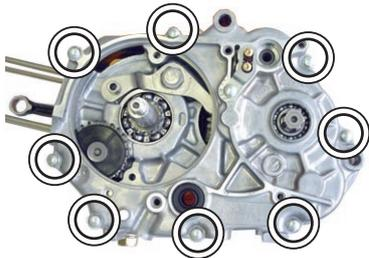
6. シフトドラムサイドワッシャの角が丸くなっている方をシフトドラム側に向け、6角ボルトを規定トルクで締め付けます。
