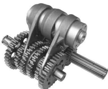
メインシャフトにキット内のカラーを取り付け、カウンターシャフト、シフトドラムを一体で、クランクケースに、組み付けます。
