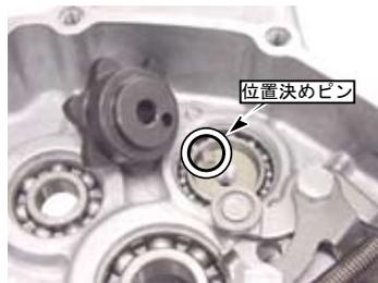
※KSR110 (CBF/DDF) の場合、クランクケースに取り付けられているポジションレバーとポジションプレートを取り外し、キット付属の物と取り替えて下さい。(ポジションレバースプリングもノーマルの物は使用しません。)
