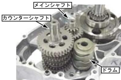
○各シフトフォークの爪部分にエンジンオイルを塗布し、フォークを各ギアの溝に差し込みます。
