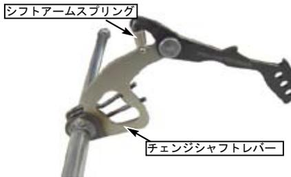
○キットのチェンジシャフトを写真の位置で差し込み
