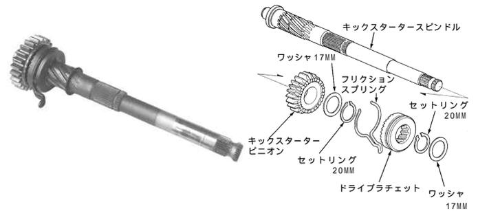
キックスターースピンドルよりワッシャ17MM、セットリング20MM、スタードライブラチェット、セットリング20MM、スラストワッシャ20MMスターターピニオンの順に取り外します。キックスターースピンドルにキット内スターターピニオンを取り付け、逆手順で外した部品を組み付けます。
