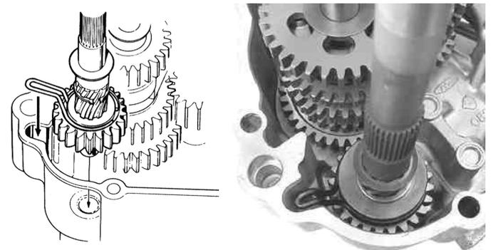
フリクションスプリングをL クランクケースの溝に合わせてスターターースピンドルを取り付けます。スターターピニオン、スターターースピンドルにエンジンオイルを塗布して下さい。
