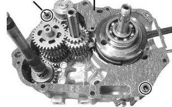
クランクシャフトをL クランクケースに取り付けます。クランクシャフト両端のボールベアリングとコネクティングロッド大端部分にエンジンオイルを塗布して下さい。クランクケース合わせ面を脱脂し、ノックピン2本と新品のクランクケースガスケットを取り付けます。
