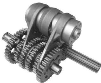
適当な台を用意し、L クランクケースを置きます。メインシャフトとカウンターシャフトのギヤを噛み合わせ、シフトフォークをギヤの溝にセットします。各ギヤ、シフトドラム、シフトフォーク、ベアリングにエンジンオイルを塗布して下さい。
