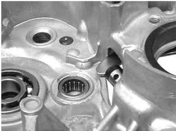
L クランクケースの 印部分をプライヤなどで折り、ヤスリやリューターで図の斜線部分を削ります。ベアリング部分にゴミや切り粉が入らない様にテープなどでマスキングして下さい。ケースのエッジ部などで手を切らない様、手袋を使用し、作業を行って下さい。
