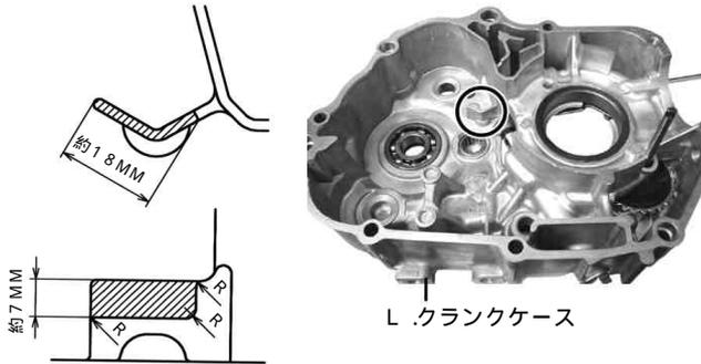
クランクケース合わせ面のガスケットを剥がします。合わせ面に傷や歪みがあればオイルストーンを使用して修正して下さい。
