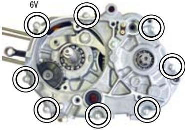
○⑲ギアシフトドラムサイドワッシャの角が丸くなっている方をシフトドラム側に向け、⑳6角ボルトを規定トルクで締め付けます。
