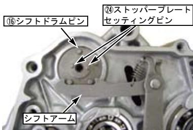
○⑰ギアシフトドラムサイドプレートの穴を㉓ストッパープレートセッティングピンに合わせて取り付けます。
