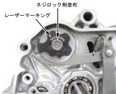
○㉕シフトドラムストッパーアーム COMP. に㉖シフトドラムストッパースプリングをセットし、⑩ギアシフトドラムストッパープレートに合わせてケースに取り付け、規定トルクで締め付けます。※指を挟まないように十分注意して下さい。
