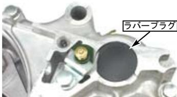
○右クランクケースを上にし、スタータースピンドルにキックスタータースプリングとキックスプリングリテーナーを取り付け、スプリング端部をケースに引っかけます。㉑エキスターナルサークリップを取り付けます。※指を挟まないように十分注意して下さい。
