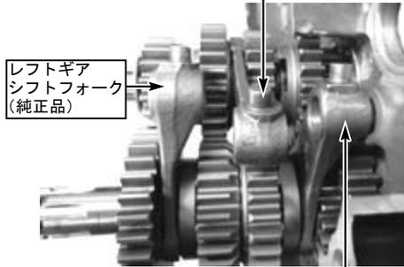
○シフトドラムを組み付け、各シフトフォークの突起をシフトドラムに組み合わせ、シフトフォークシャフトを組み込みます。
