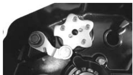
☆純正のギアシフトスピンドルの個体差により、シフトダウン操作が困難になる場合があります。一部のギアシフトスピンドルにその様な報告があり、その様な症状が出る場合、純正ギアシフトスピンドルのアーム部を、若干修正加工を行い対応して頂く必要があります。(解説図参照) 又、純正ギアシフトスピンドルとクランクケースのギアシフトスピンドル取り付け部とのクリアランスが大きく、R. クランクケースカバーを取り付けた状態でないと、ギアシフトスピンドルの位置が定まりません。
