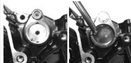
○スピードセンサー ASSY. とクランクケースの間にキット付属のワッシャ 6mm を挟み込みフランジボルト 6x18 (純正部品) で締め付けます。
