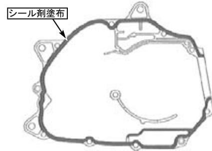
○クランクケースを組み合わせ、クランクケースボルトを組み付けます。
