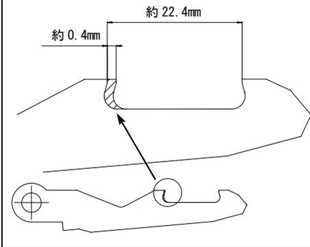
○ギアシフトスピンドルを組み込み、ドラムストッパーホルダーをソケットボルトで組み付け締め付けます。
