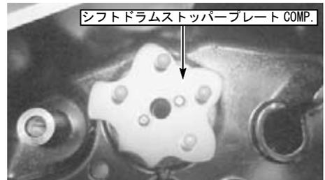
○シフトストッパープレートの穴をシフトドラムストッパーアームに組み付けます。
