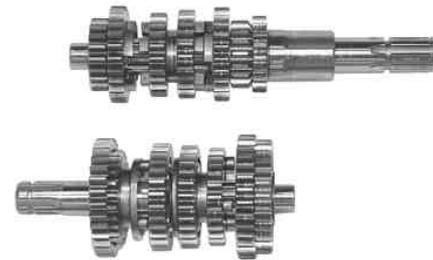
2. メインシャフト、カウンターシャフトの各ギヤ及び摺動部品にエンジンオイルを塗布し、メインシャフトとカウンターシャフトを一体でL.クランクケースに取り付けます。
