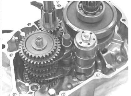
6. キックスタータスピンドルをケースに取り付け、スタータラチェットの爪部分をガイドプレートに合せてセットします。
