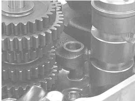
4. キット内シフトフォーク“L”をカウンターシャフト下側に、STDシフトフォークマーク“R”を上側にマークが上を向く様取り付けシフトドラムの溝にセットします。
