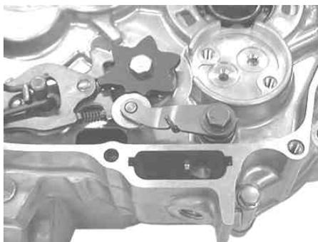
12. 手でメインシャフトを回しながらシフトストッパープレートを固定している六角ボルトを回転させて各ポジションへの作動を確認します。
