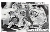
1. リターンスプリング、ストッパーアームを取り付け、ボルトを指定トルクで締め付けます。
