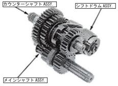
4. メインシャフト、カウンターシャフト、シフトドラムを一体で L. クランクケースに取り付けます。 ※シフトドラムを回転させ、トランスミッションの
