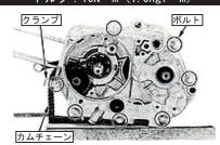
9. ワッシャ、シフトドラムボルトを取り付け、指定 トルクで締め付けます。
