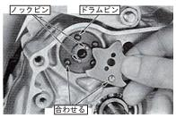
12. カムプレートボルトを取り付け、ボルトを指定 トルクで締め付けます
