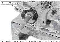
11. ギアシフトドラムにギアシフトドラムピン4本、 . イアンプトドラムにイアンプトドラムビンチが、 ノックピン2本を取り付ける。 カムプレートの穴と溝をノックピンとドラムピン に合わせ、カムプレートを取り付けます。
